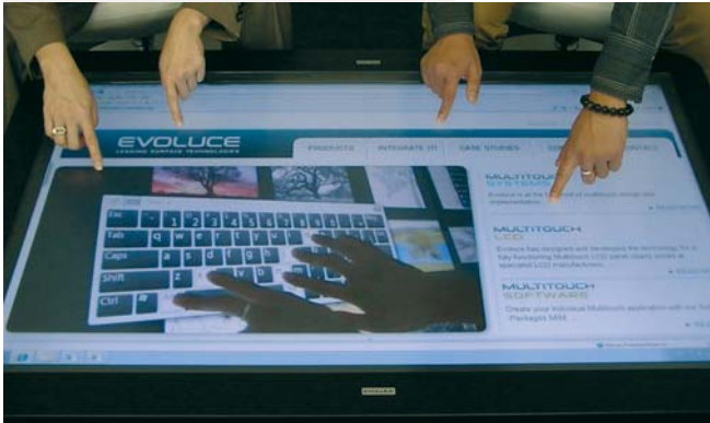
LCD-Bildschirm mit patentierter sensibler Multitouch-Oberfläche (Rechner optional). Für Bedienung sitzend (Einbau) oder stehend und in Wand.
